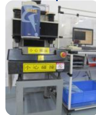
3D OGP flash 200 measurement instrument 3D光学测量仪（精度 0.001mm）
