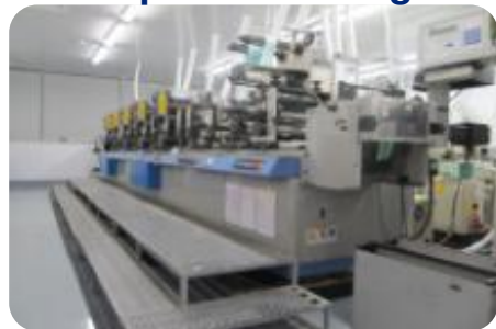
Lintec 5C+1 五色凸版印刷机
